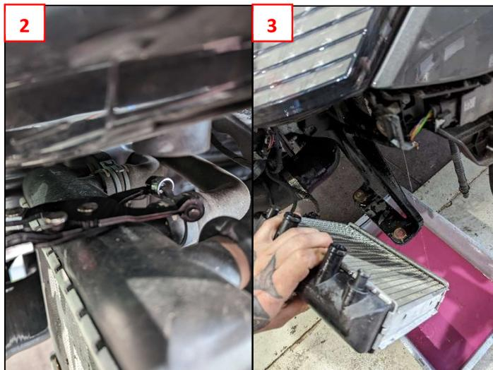
Demontieren Sie die Kühlerträger aus den seitlichen Bauräumen. Setzen Sie anschließend die serienmäßigen Gummilager in die mitgelieferten WT-Kühlerträger (001002519 & 001002520) ein (**4**).
