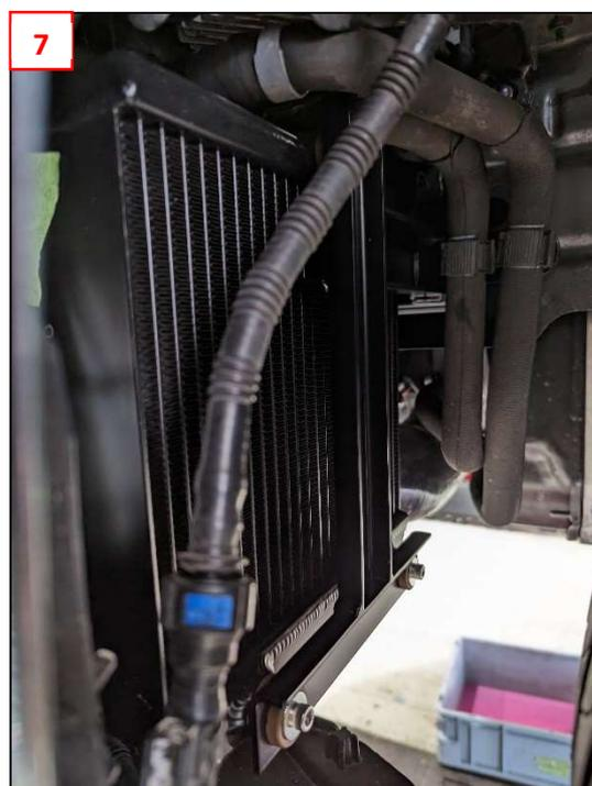
Montieren Sie die Luftführungen an den WT-Wasserkühlern (8). Montieren Sie die restlichen Bauteile in umgekehrter Reihenfolge und Befüllen sowie Entlüften Sie den Kühlmittelkreislauf.
